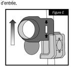
Finissez l'alésage de la face en plaçant la fraise dans le trou à l'arrière de la porte et continuez à percer à travers le gabarit True-Guide™ jusqu'à la fin du trou.
