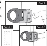
3. CÓMO PERFORAR LOS ORIFICIOS DEL FRENTEY EL ORIFICIO DE LA PLACA DEL PESTILLO. Sujete la sierra cilíndrica de 5,40 cm (2-1/8") al mandril o broca de guía (figura C). Inserte firmemente la sierra cilíndrica y el mandril en el taladro.
